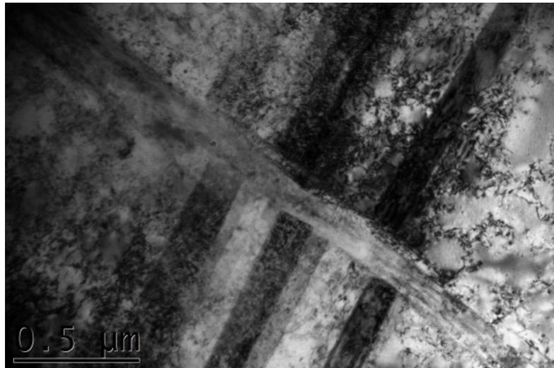
FIGURE 1 – Forte densité de dislocations et deux systèmes de macles en interaction dans un échantillon laminé (formula 25%).
