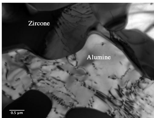
FIGURE 1 – Image en champ clair de dislocations dans les phases alumine et zircon.
